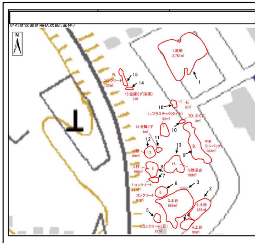
図 2.6.2 岩手県における現地測量結果の例 資料提供：応用地質(株)
