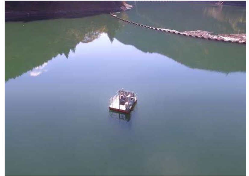
▲自動濁度計 全景
