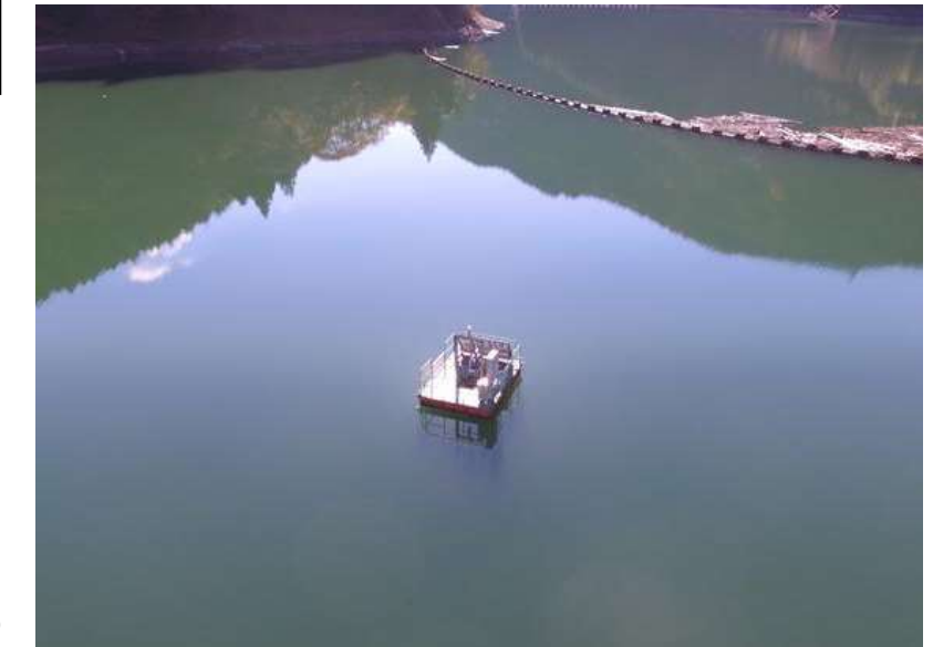
▲自動濁度計 全景
