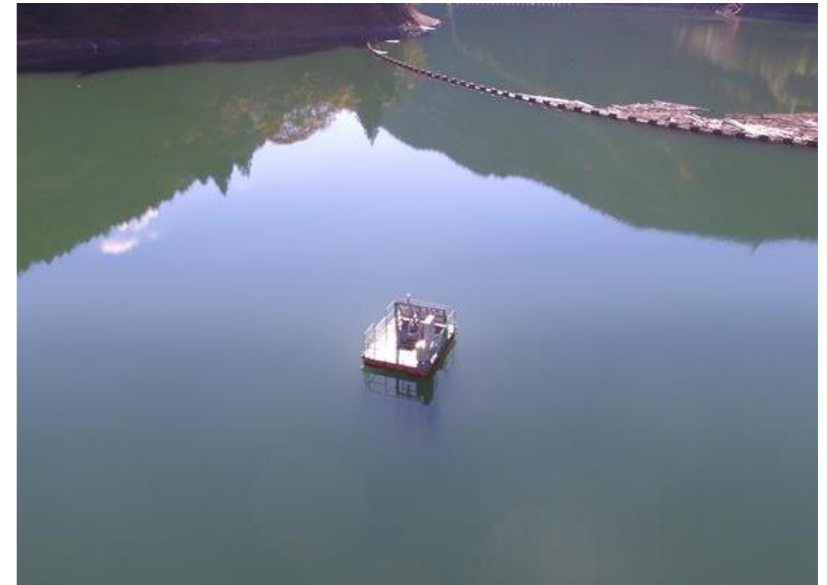
▲自動濁度計 全景
