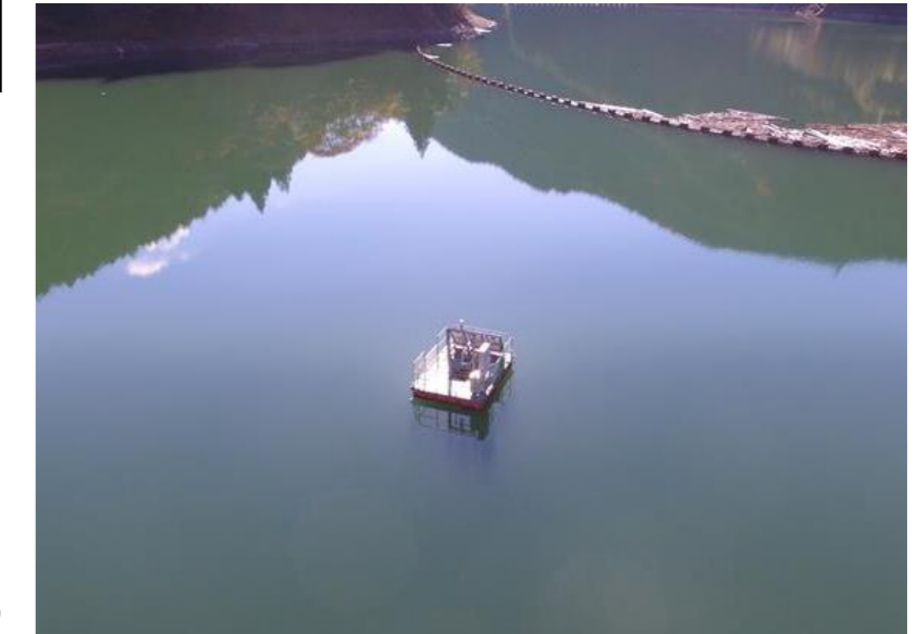
▲自動濁度計 全景
