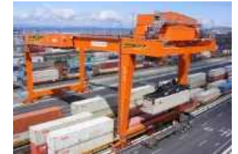
RMG(レール式トランスファークレーン)
