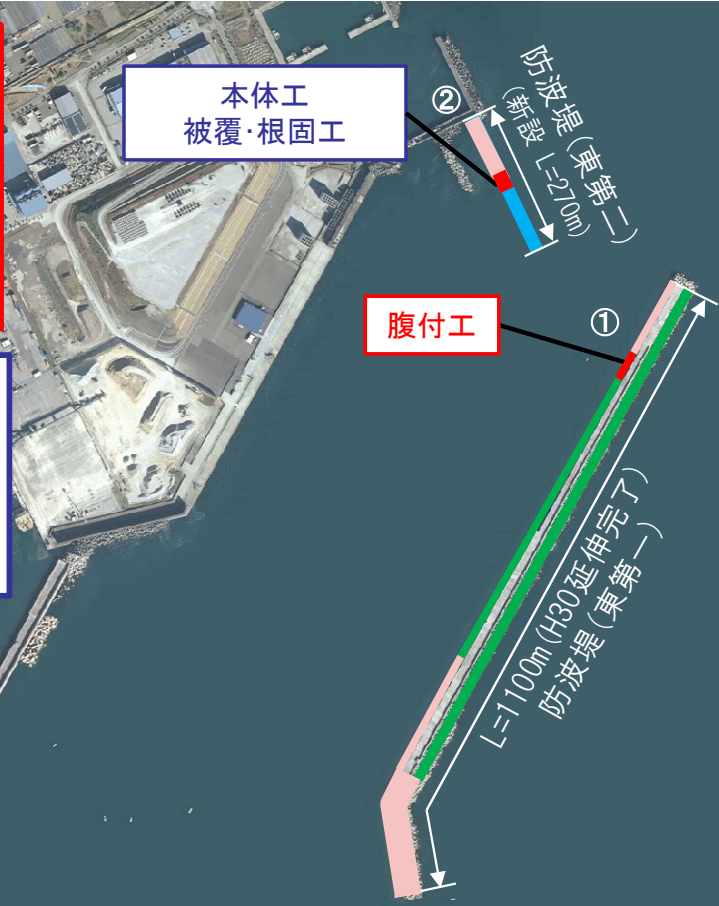
②防波堤(東第二) (高知県施工) 本體工 被覆・根固工 (R5.5撮影)
