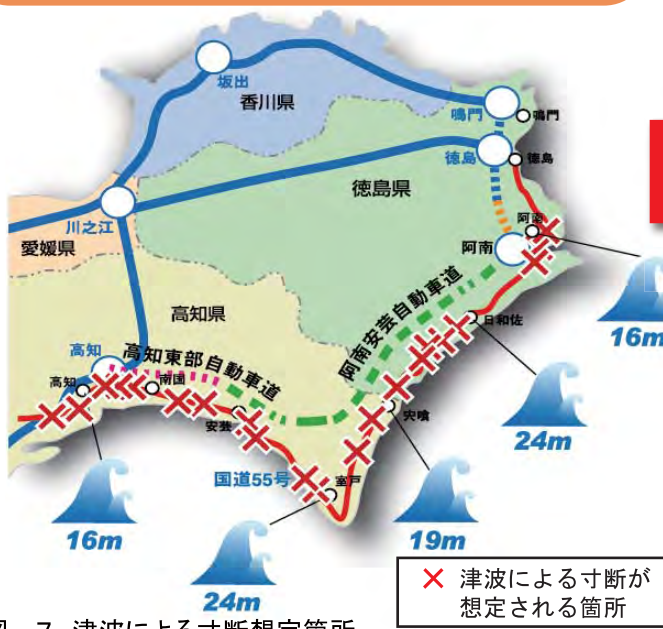
図-7 津波による寸断想定箇所
