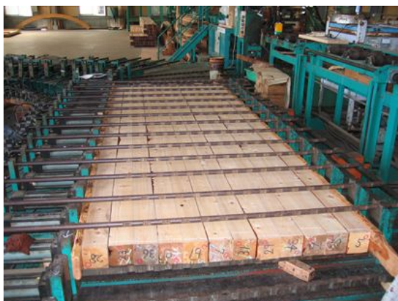
図 1. 接着重ね梁の製造状況 (油圧プレスによる製造)
