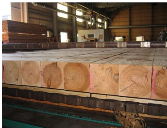
図 1. 接着重ね梁の製造状況 (油圧プレスによる製造)
