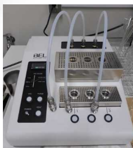
真空加熱装置 (前処理装置)
