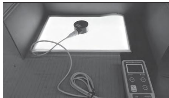
写真9 透過光照度テスト全景
