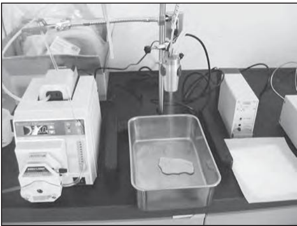
写真5 定量ポンプと組み合わせた超音波アトマイザー装置
