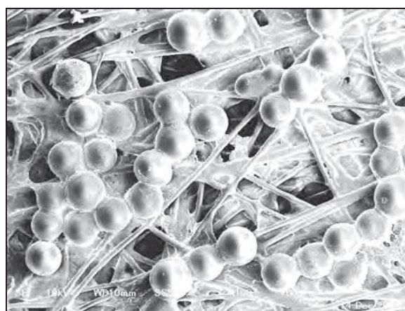
写真7 ドライボン添加による複合シート(φ0.1mm)の表面画像(倍率100倍)
