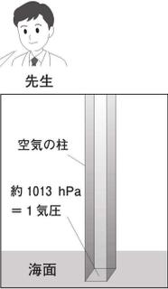
図 気圧を空気の柱で表す
