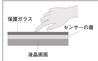
図 タッチパネルの模式図(断面)
