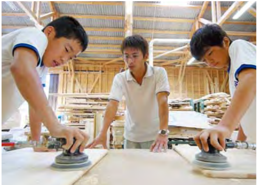
地元の先輩でもある集成材工場の職員の方にコツを教えてもらいながら、電動ヤスリで作業する子ども達。この工場では、地元の間伐材を板状にして組み合わせ、接着、圧縮、乾燥することで、美しい木肌の集成材を作っている。
