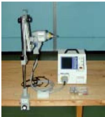
写真1 静電気放電試験器
