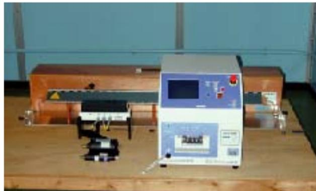
写真2 ファストランジェント/バースト試験器
