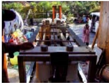
写真2 試作搾汁機
