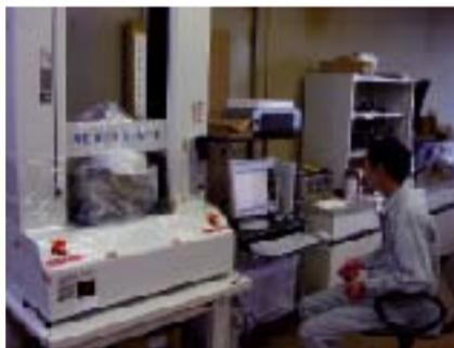
写真4 搾汁率測定試験
