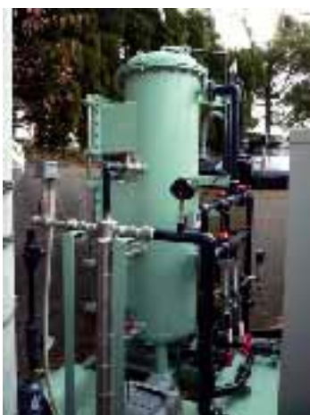
図3 吸着材充填槽（左）とプラント全体写真（右）
