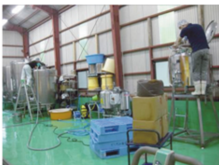
発酵タンクへの仕込み
