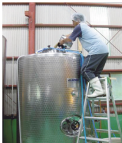
発酵タンクへの酵母投入
