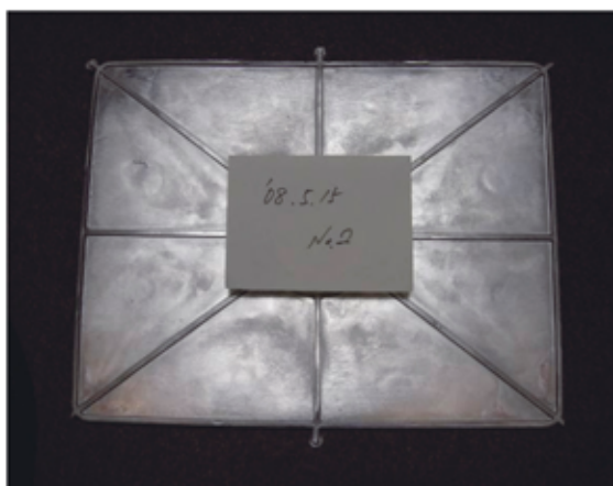
図5 試作ダイカスト品の例 (2mm厚×600mm×400mm)
