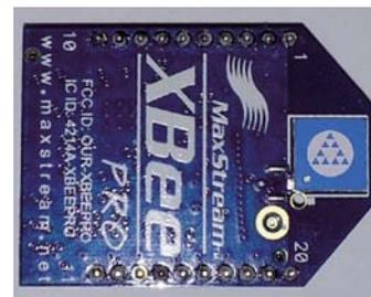
Zigbee (Xbee) モジュール
