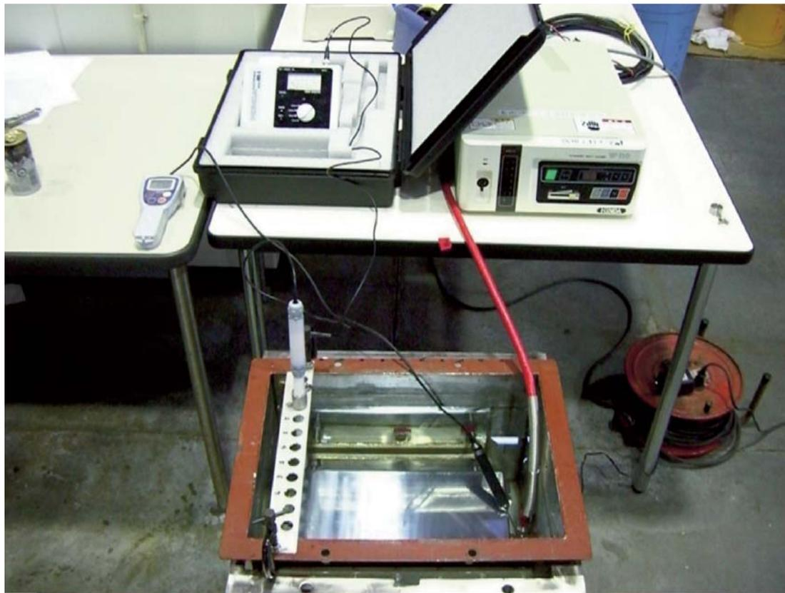
写真1 超音波照射装置
