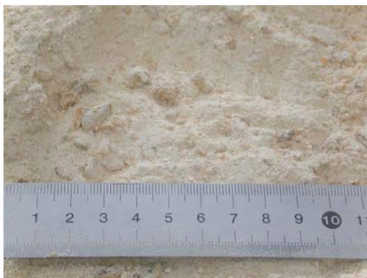
図3 搾汁残渣：生石灰が 1:0.5 のとき
