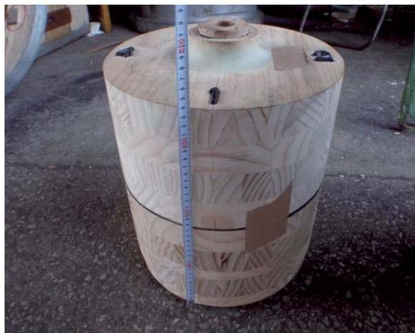
図3 円筒状試験鑄型用模型
