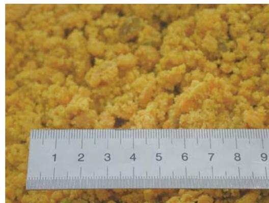
図4 搾汁残渣：生石灰が 1:0.1 のとき
