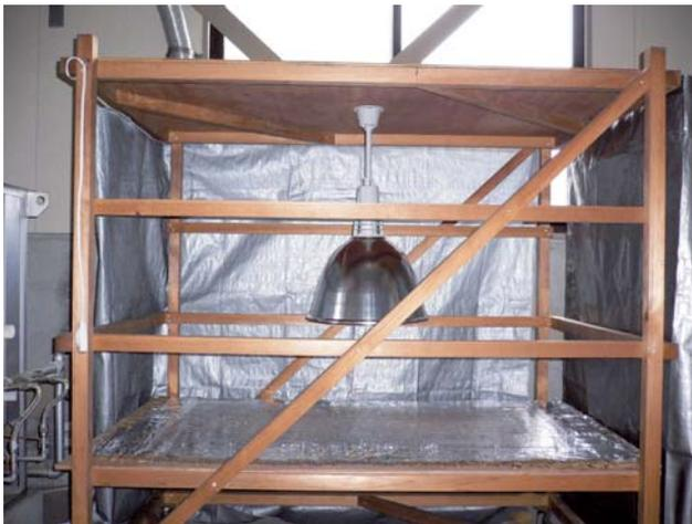
木枠の大きさ：間口 150cm、奥行 110cm、高さ 100cm（ランプ取り付け位置から試料棚までの高さ）
