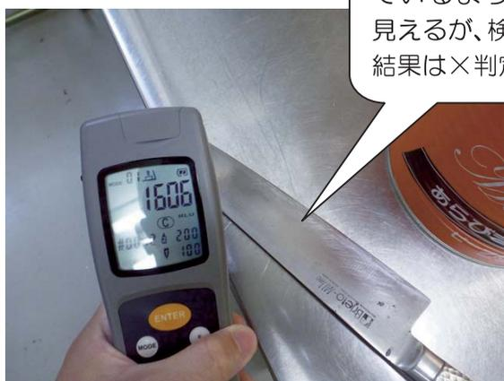
よく洗浄されているように見えるが、検査結果は X 判定。
