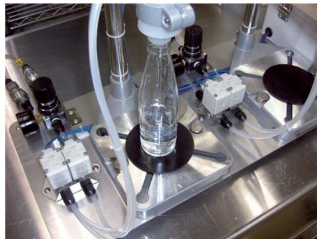
図4 炭酸水の充填試験
