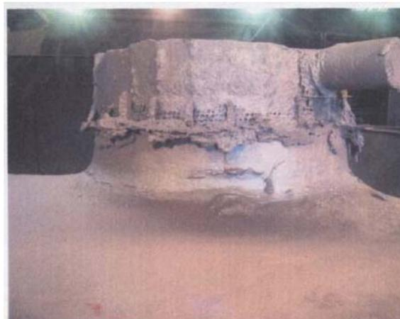
図1 焼着欠陥の様子
