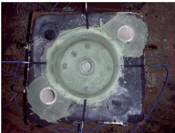
図4 鑄型内の温度測定箇所
