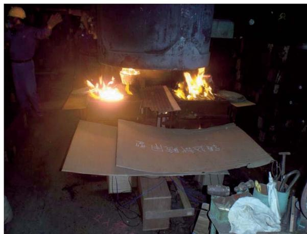
図5 温度測定実験の様子（鑄込み時）
