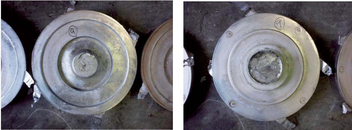
図2 新マシンで成型したエンジン部品（左：上型面、右：下型面）
