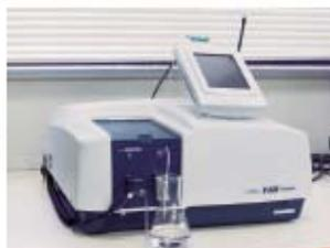
液体食品の色合いは製造ロットによって異なったり、保存条件によって変化したりします。分光光度計は、ヒトの目では区別できないような液体食品の微妙な色合いの変化を確認できます。
