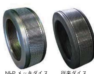
図3 試作したダイスと従来ダイス
