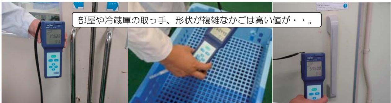
また、上の写真のかごや包丁の持ち手のように、表面に凹凸がある器具では値が高くなる傾向があり、素材によっても汚れの落ちにくさが異なる傾向がありますので、特に注意して洗浄を行う必要があります。検査結果が不合格であったり、要注意の場合でもあまり値が大きいと洗浄不足が考えられますので、再度洗浄後もう一度測定して確認するようにします。できるだけ清潔に管理することが求められる食品製造現場では、扱う器具や設備を金属製などの汚れの落としやすい素材や形状にすることも、毎日の洗浄や衛生管理をしやすくするための一つの方法です。
