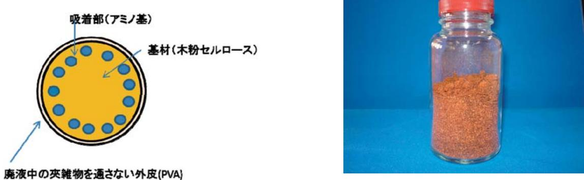
図1 木粉を基材とした吸着材
