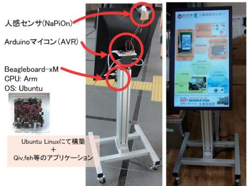
図2 スタンドアローン型システム
