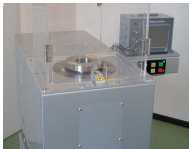
図 2 動バランス調整装置
