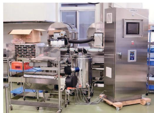
図2 (株)垣内製小型凍結濃縮装置
