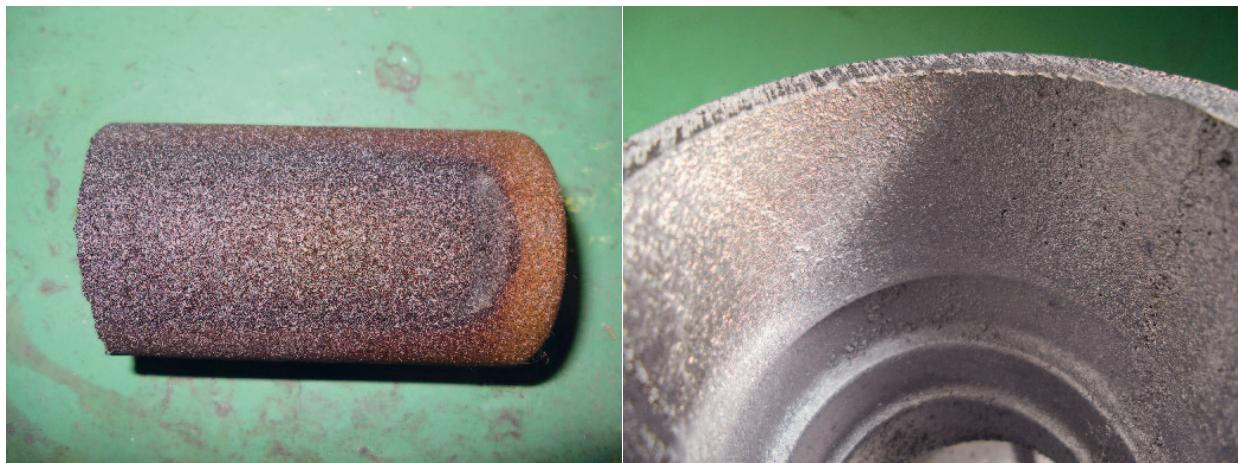
図2 中子表面の焼損具合（左）、鋳造品の表面状態（右）
