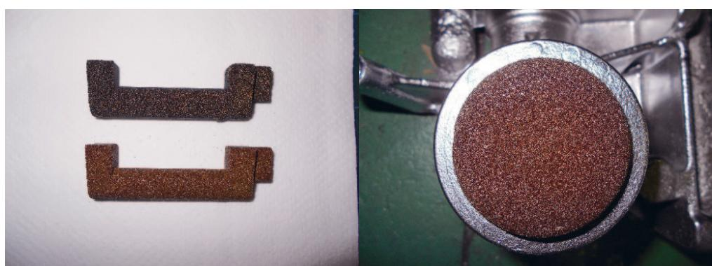
図 1 中子試験片（左）、鋳造試験（右）
