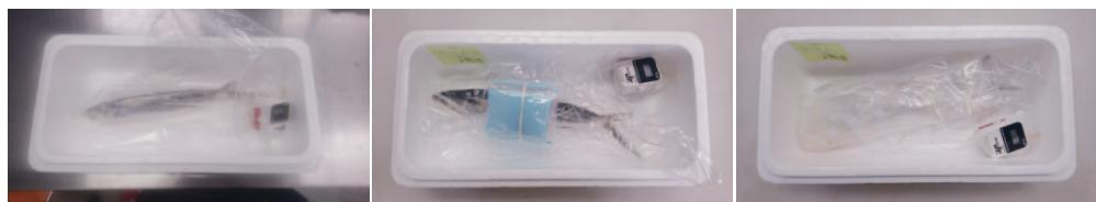
図 3 冷凍魚を使った保冷効果の確認（左：処置なし 中：市販保冷剤 右：試作不織布保冷剤）
