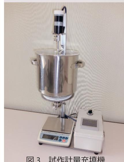
図3 試作計量充填機
