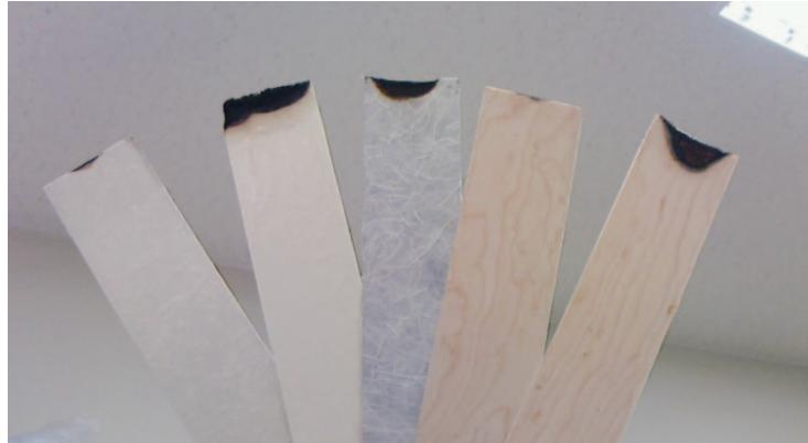
図2 JISに準じたバス向け内装材の試験体
