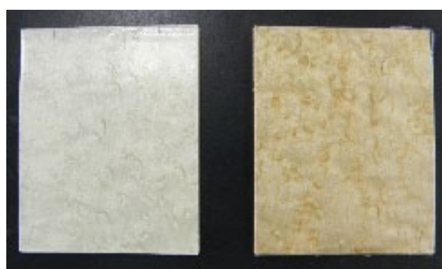
図2 インサート成形した突き板
