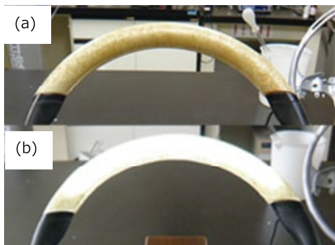
図4 脱色突き板のハンドル形状試作物
