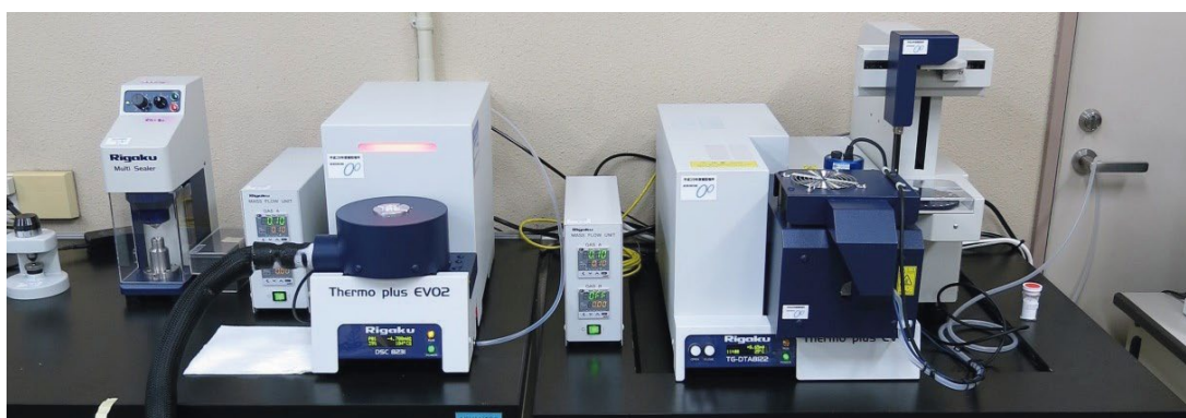
図1 導入された熱分析装置：左側がDSC、右側がTG-DTA
