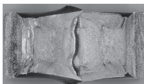
衝撃試験片破断面デジタルマイクロ스코プ画像 （倍率 約 20、 -40^{\circ}\text{C} 冷却、左：FC250～300 相当、右：SUS304、）
