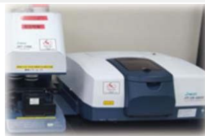
全自動赤外顕微鏡 マルチチャンネル赤外顕微鏡
