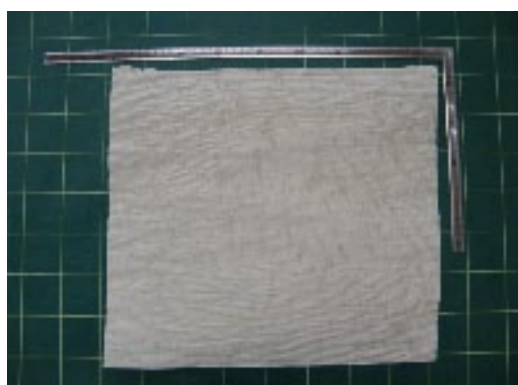
図1 脱色後、乾燥した突き板
