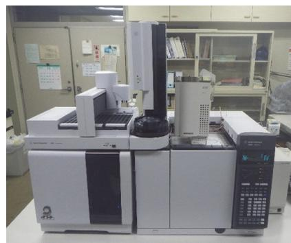
図1 パイロライザーガスクロマトグラフ質量分析装置
