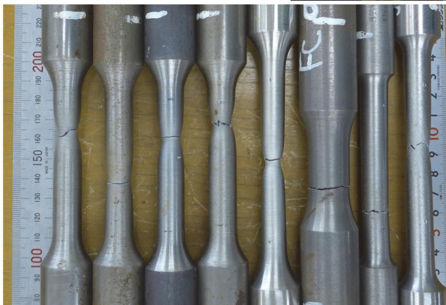
実習で使用した引張試験片(試験終了後)
