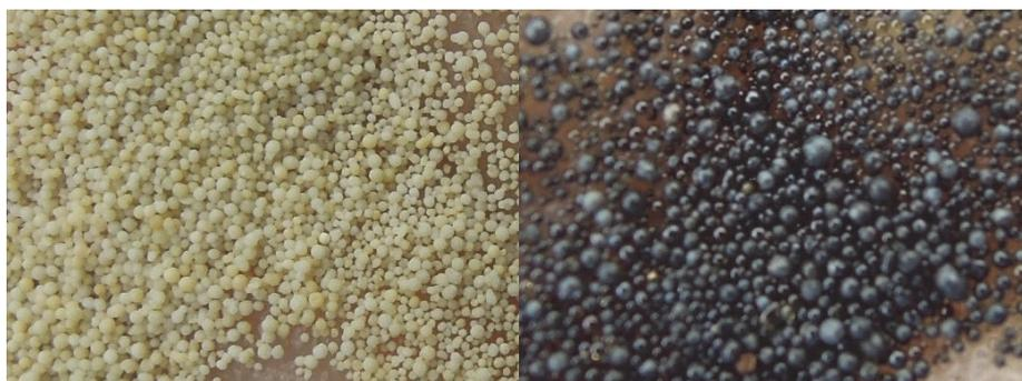
図1 左：焼結系アルミナ人工砂、右：溶融系アルミナ人工砂
