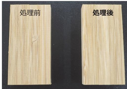
図2 シランカップリング処理前後における竹集成材の外観
