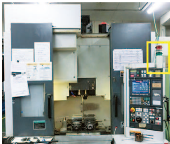
図 3 パトランプがある加工設備
