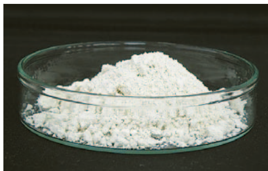
図2 回収した粉末状 CNF 反応物
