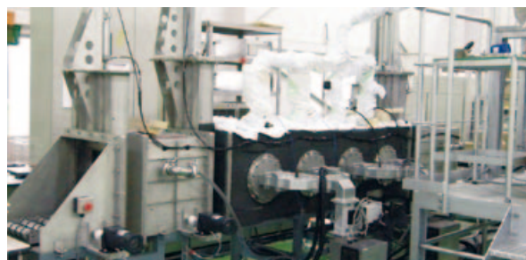
図6 マイクロ波出力 6kW の試作機
