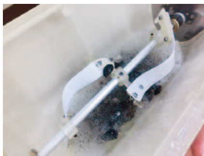
図 10 攪拌羽根の改良案
