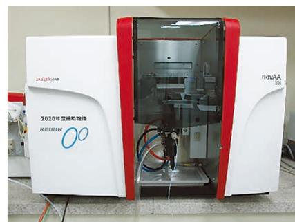
図1 原子吸光分光光度計「フレーム法・水素化物発生法」
