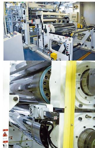
図 1 紙産業技術センターの精密熱カレンダー装置（上）とその加熱加圧ロール（下）
