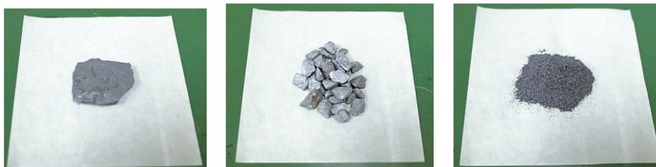
図3 接種剤粉碎の様子（左：塊状、中：破碎後、右：粉碎後）
