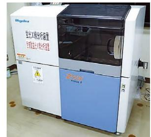
図 1 XRF 装置
