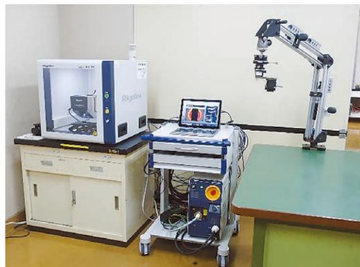
図1 可搬型 X 線残留応力測定装置
