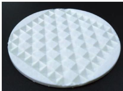
紙由来の高強度素材（バルカナイズドファイバー）の切削加工試作品
