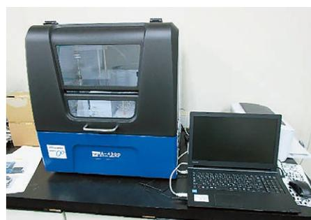
図2 原子吸光分光光度計「還元気化法」
