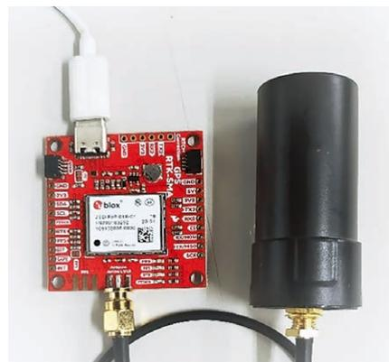
図 1 GNSS 受信機とアンテナ
