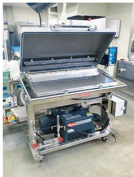
図2 自動真空ガス包装機
