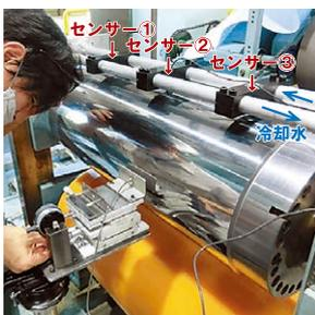
図5 センサーの校正
