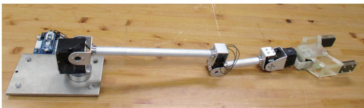
図2 製作したロボットアーム
