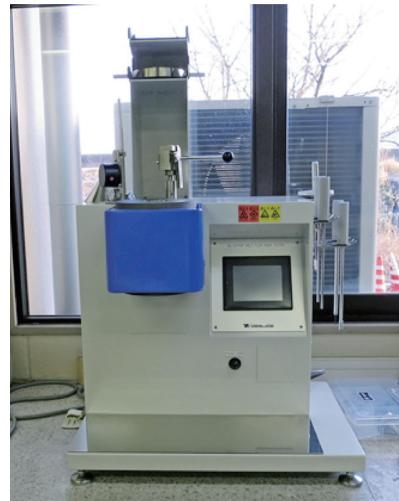
図 1 溶融樹脂流動性測定装置
