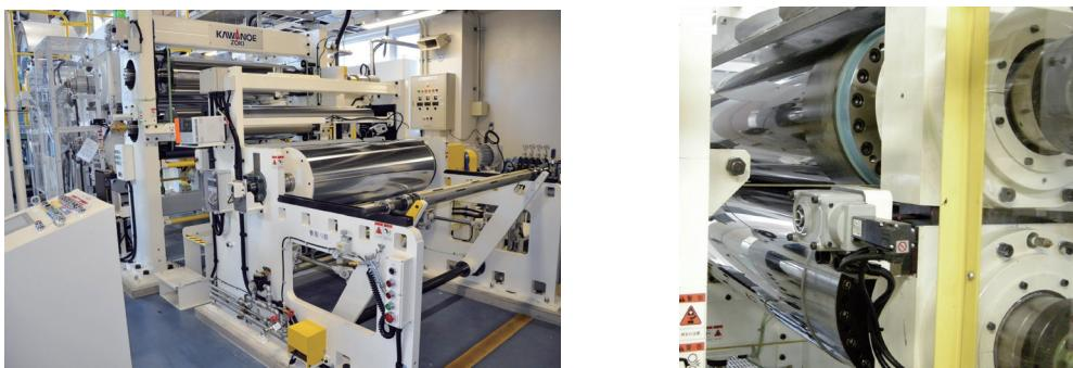
図 1 紙産業技術センターの精密熱力レンダー装置（左）とその加熱加圧ロール（右）
