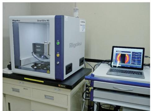
図2 可搬型X線残留応力測定装置
