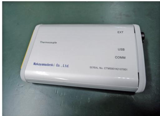
図3 超高速度温度測定装置
