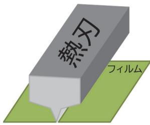
図1 溶断製袋プロセスの概略図
