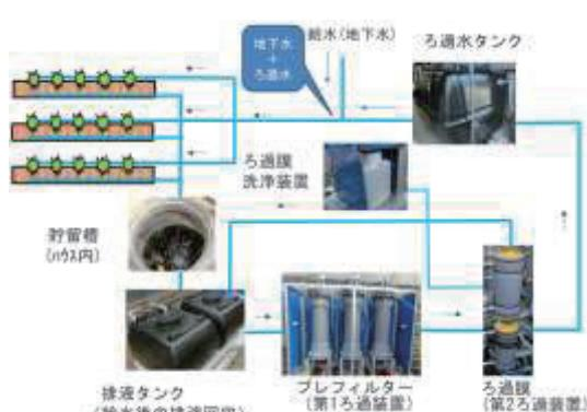
循環式養液栽培用高性能養液ろ過装置
