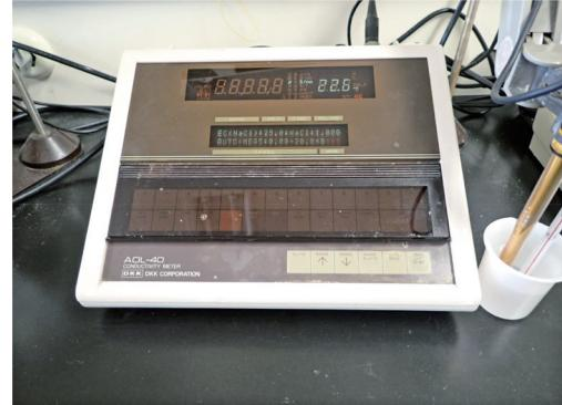
図 1 電気伝導率計 (DKK AOL-40)
