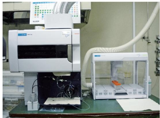
図 1 ICP 発光分光分析装置
