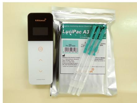
図2 ATP 検査器
