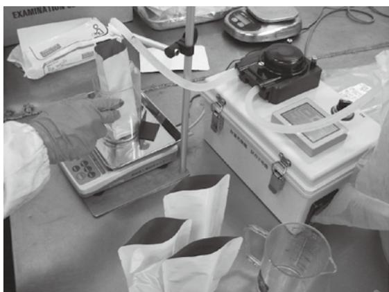
図6 鶏ガラスープを充填する現場試験
