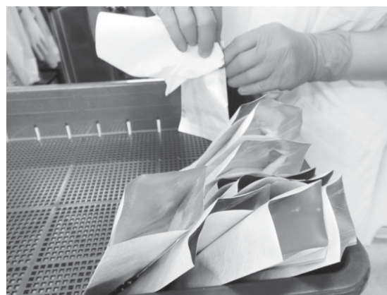
図10 熱シール部に付着した粉末を除去
