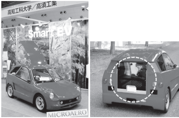
図5 製作した小型電気自動車とリアドア取り付け例
