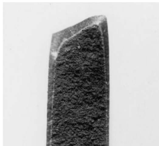
図8 20%粉炭配合焼成体の破断面
