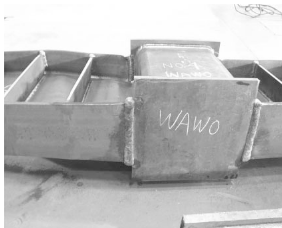
図5 3点曲げ試験終了後のWAWO工法仕口
