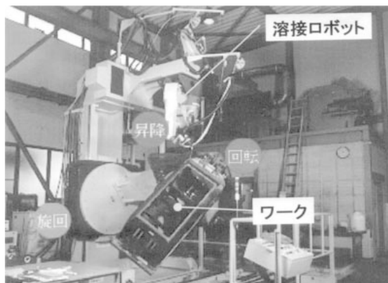
図1 溶接ロボットシステム
