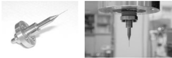
写真2 焼きばめ実装 写真3 主軸への装着
