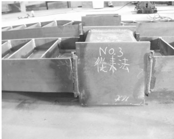
図7 3点曲げ試験終了後の従来工法仕口
