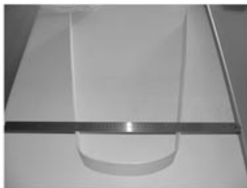
図5 側板の開き測定
