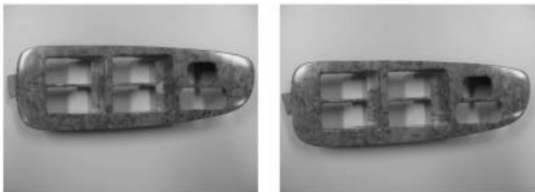
写真6 セイカビームPU-5 (NS-58S1) (左：膜厚2.6 \mu m、右：膜厚5.2 \mu m)
