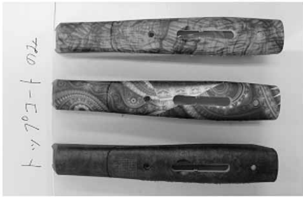
図6 試作品 ( ⑤-1 ) の促進耐候試験結果 左 ; 試験前、右450MJ照射後
