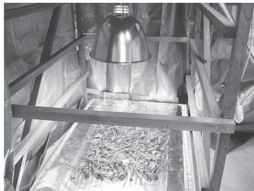
図1 人工光乾燥に使用した装置
