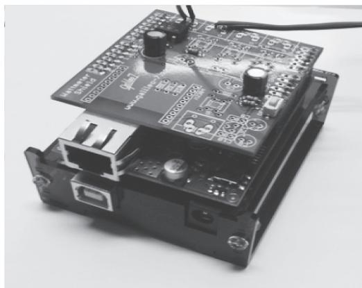
図7 Arduino 本体基板に LAN シールドと電流センサ用のシールドを搭載した様子
