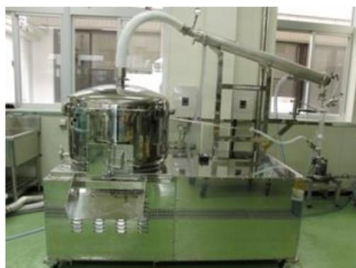
図 3 精油成分抽出用減圧蒸留装置
