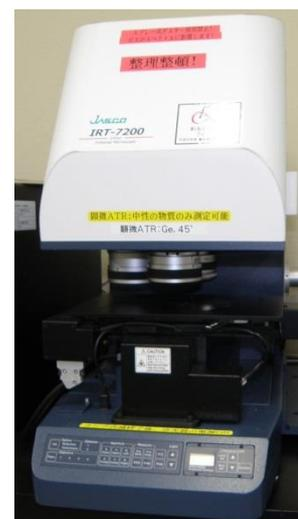
顕微赤外分光装置は測定サンプルの赤外吸収スペクトルを測定する装置です。赤外吸収スペクトルを測定することで、対象物の分子構造や状態といった特性を観察することができます。
