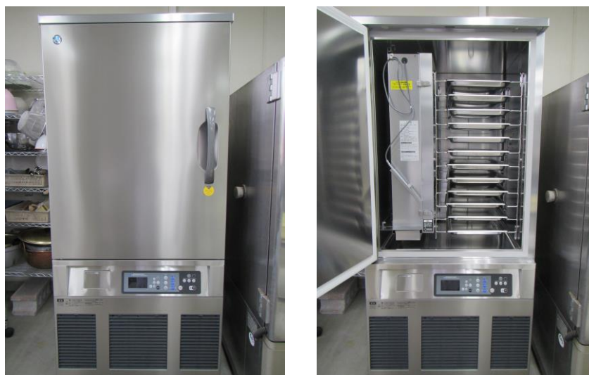
図3 超急速凍結機の外観と内部
