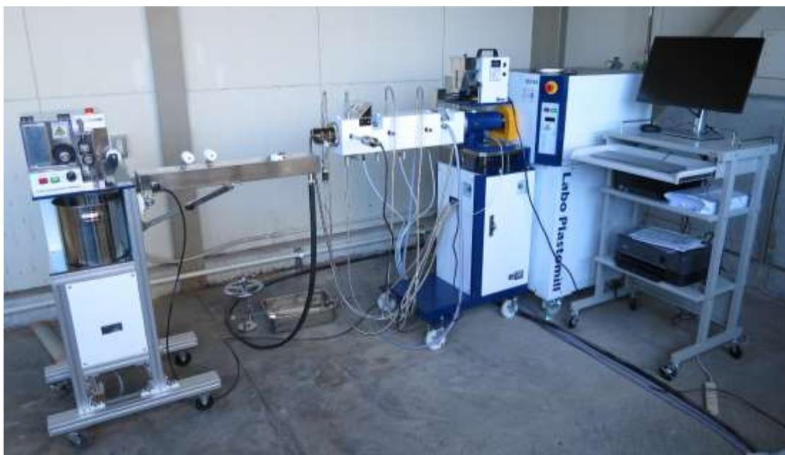
多軸混練攪拌システム（株式会社東洋精機製作所）
