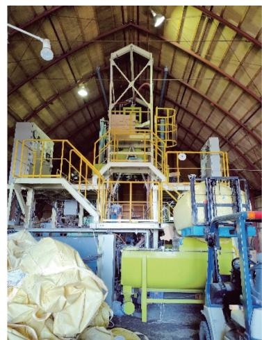
図3 バイオコークス製造装置
