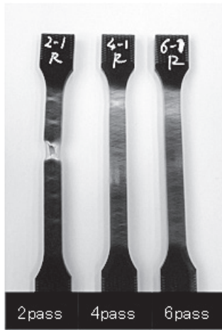
図1 pass数違いによるダンベル型試験片の変形状態
