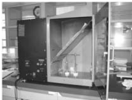
図1 難燃性試験状況
