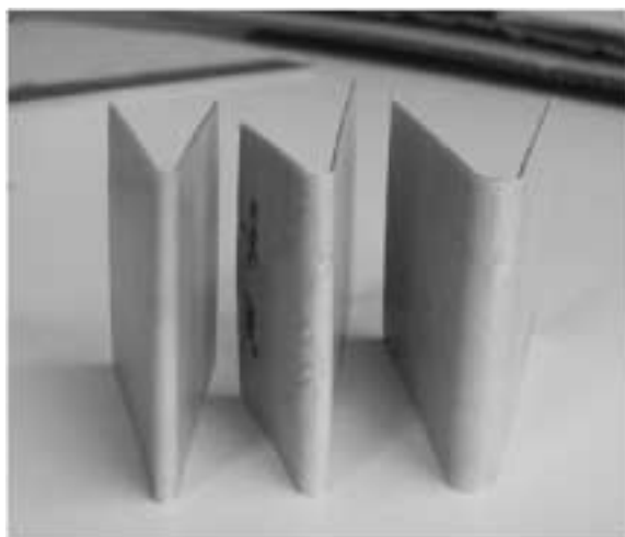
図6 折り曲げ加工した突き板シート (左からマンドレル直径2mm、5mm、10mm)
