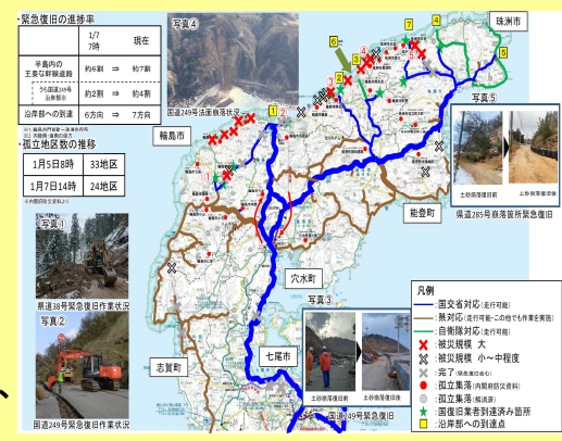
令和6年能登半島地震 道路緊急復旧状況 (R6.1.8時点) 出典：国土交通省資料
