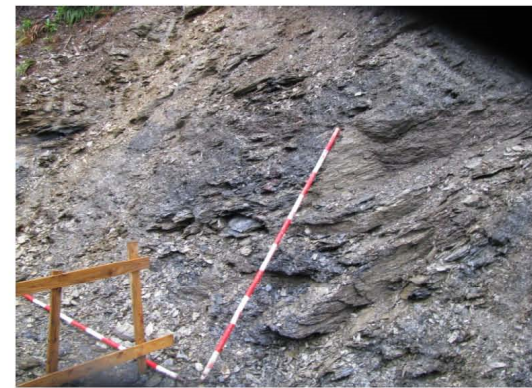
終点側岩盤状態は剥離性に富む
