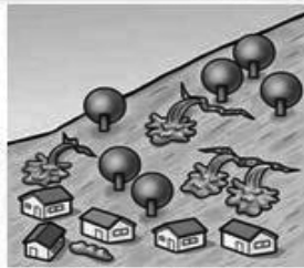
地面がひびわれ、わき水が出る
