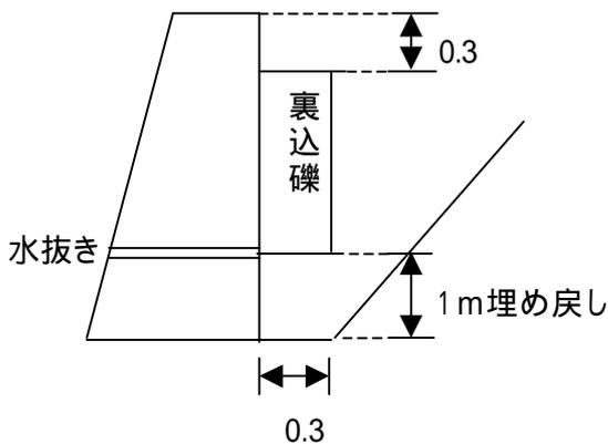
土留工の裏込礫は基礎が土砂の場合は基礎から1.0mは施工しない。
