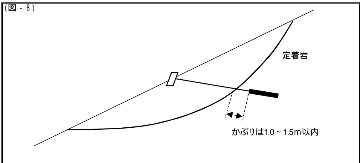
アンカ - の自由長の最小長は4.0mとする。また、長さは0.10m単位とする。理由として、極端に短くなるとアンカ - される構造物に地盤を通じてアンカ - 体から直接応力が作用したり、地盤のせん断抵抗や土塊重量が小さく十分な引き抜き抵抗力が得られなくなるなどの理由から最小長を4mとする。(地盤工学会基準)
