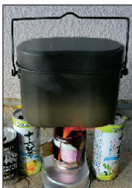
【空き缶を使った加熱手段】 ロング缶2本を台にし、それより直径の大きく低い空き缶に市販の携帯固形燃料を入れたレンジで、飯盒炊爨を行った。
