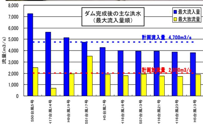
管理開始以降の40年間で、計画最大流入量を超える洪水が4回発生(計画では80年に1回)し、ダム下流で浸水被害が発生
