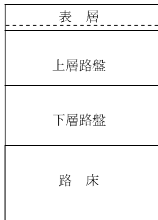
図1 アスファルト舗装の構造
