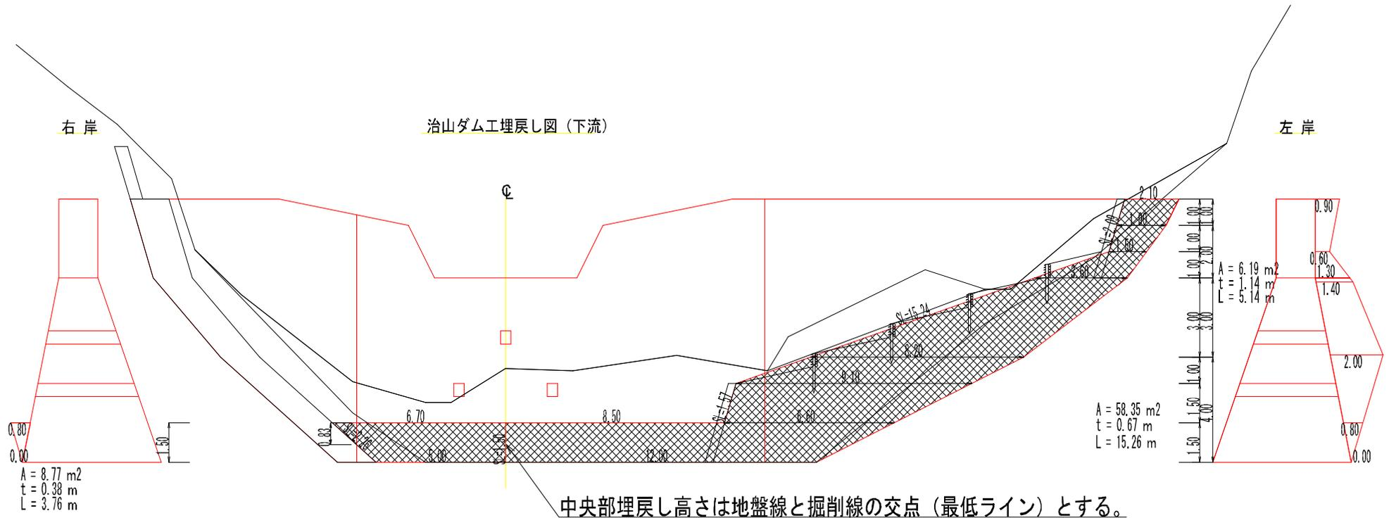
当初埋戻し計算は岩間詰数量計算方法による。
