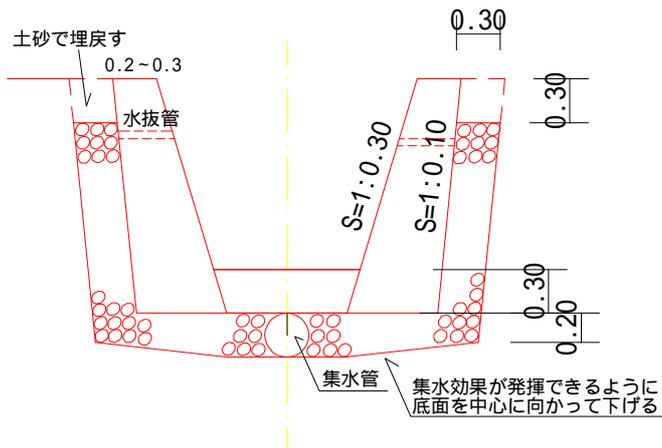
備考 地すべり地等側圧を受ける場合の側壁天端は0.30mとし、帯工天端は0.50mとする。
