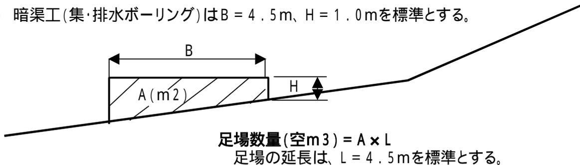
(4) アンカー工・暗渠工の足場は標準タイプであるため、設計変更により調整すること。
