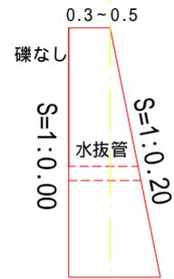
備考 地すべり地等側圧を受ける場合の側壁天端は0.30mとし、帯工天端は0.50mとする。
