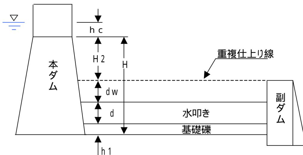
水叩き厚さはウォータークッション付きの場合、有効落差に注意して施行すること。水叩き厚さは原則として、0.5～1.5mとするが、厚さが1.2m以上になる場合は水叩き保護のためウォータークッションを設置すること。ただし、溪床が急峻な場合は、1.5mを越える厚さになってもやむを得ないものとする。水叩きの側壁の安定計算に用いる摩擦係数は0.7とする。
