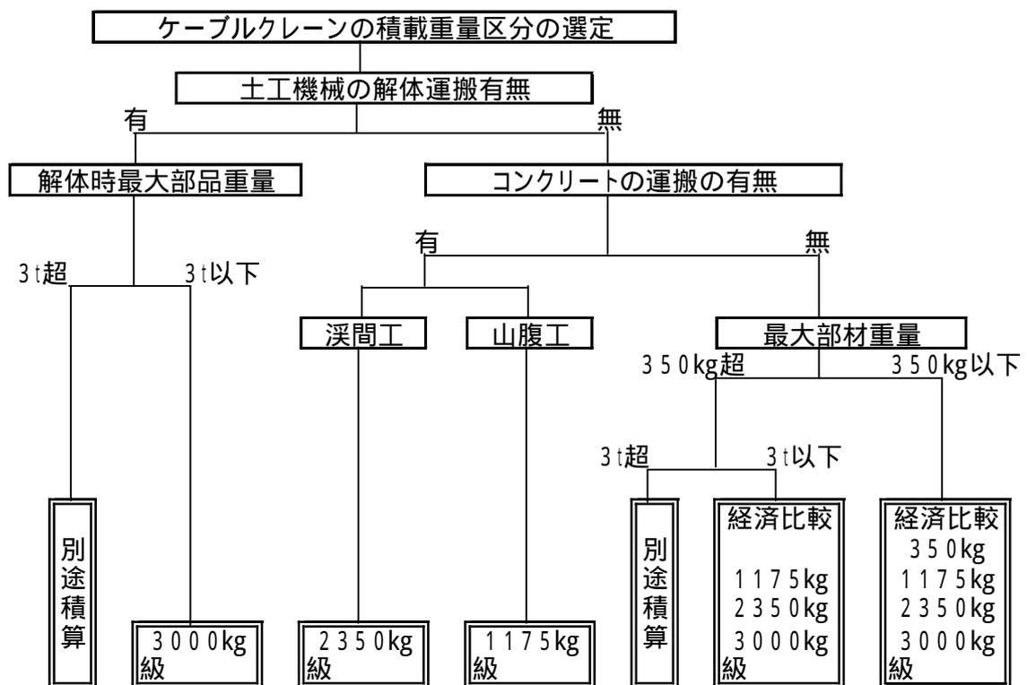
溪間工と山腹工を併せて施工する場合は、資材運搬重量（捨土重量を除く）の大きい方とする。
