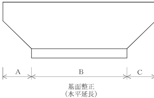
※ A・B・Cは展開図上の水平延長とし、面積を算出する。
