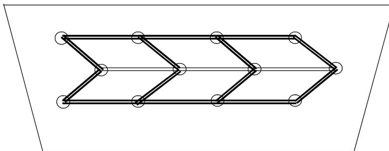
注) 水抜きを暗渠排水材により連結する。
