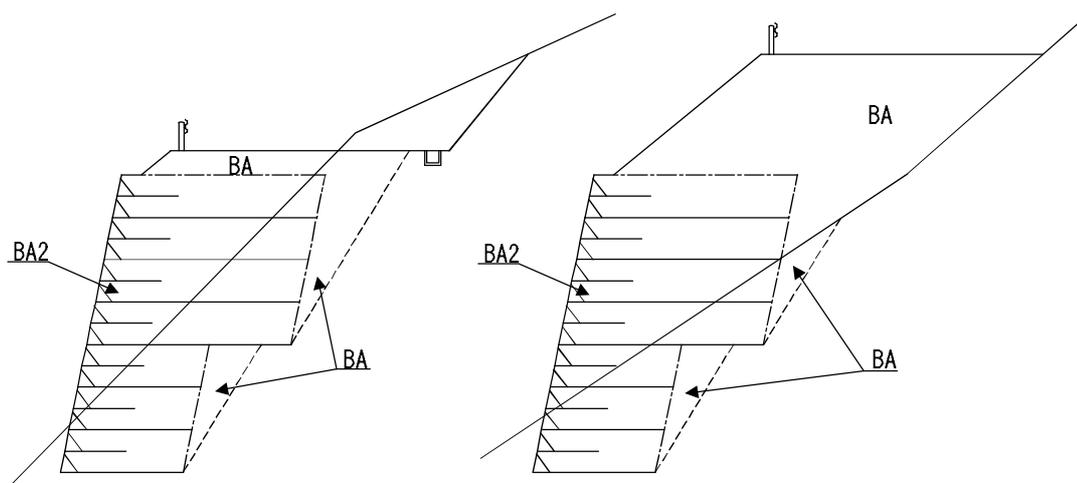
[BA2] : 流用は行うが、敷均し締固め費用は計上なし。(施工歩掛に含む)
