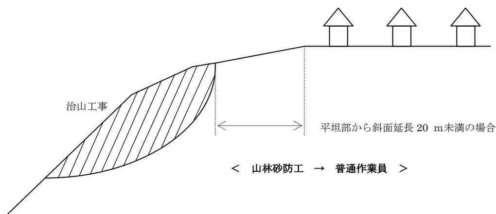
※ 道路、宅地等の平坦部と近接しており、砂防工事と同種と見なされる工事と、運搬距離100m以上のケーブルクレーンを架設する工事が混在する場合は、それぞれ山林砂防工、普通作業員を適用する。
