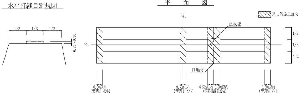
管理ポイント等で凸を未施工とする場合は下図により、差し筋（異形棒鋼D16mmSD345）の必要本数を一定間隔かつ均等に配置する。
