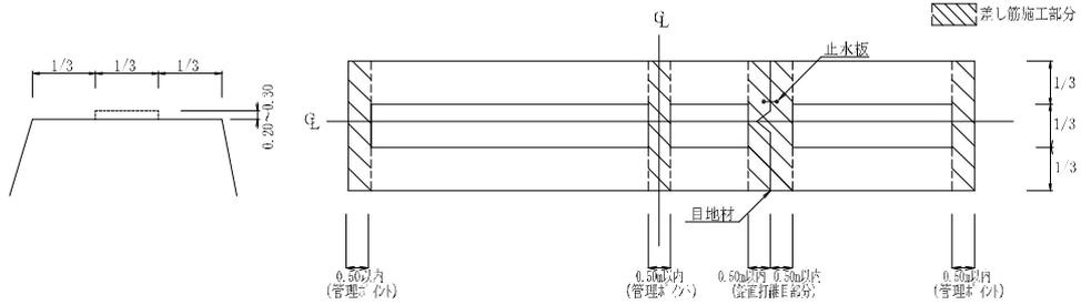
管理ポイント等で凸を未施工とする場合は下図により、差し筋（異形棒鋼D16mmSD345）の必要本数を一定間隔かつ均等に配置する。
