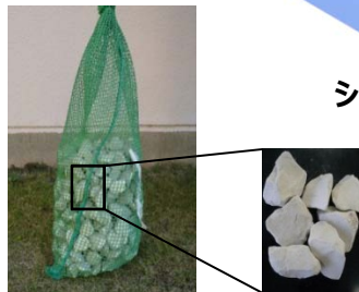
放射性物質吸着剤 (ゼオライト) (雨水排水弁等に設置)
