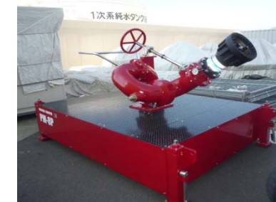
放水砲 (大型2台)
