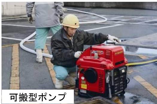
図②-1-5 浸水対策設備配備場所
