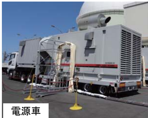
図②-1-4 浸水を想定した代替電源、注水設備
