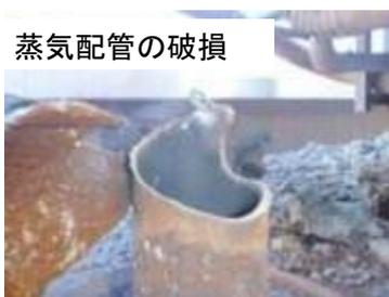
図⑫-2-1 蒸気配管の破損
