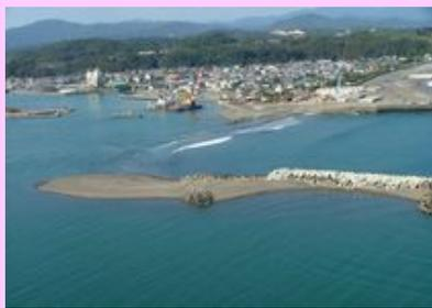
いったん形成されていた砂洲が波浪により流失。碎波状況から水面下に形跡は見られるが、航路への波の影響が再度現れている。
