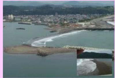
目視で+0.5m程度の高さまで復元されている。9 / 19に推定した砂州位置からさらに50mほど上流に移動したものの、過去の写真に見られるよう本来の位置に近づいている。
