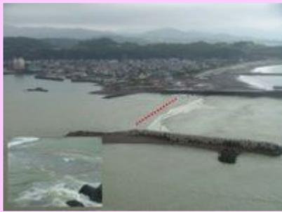
突堤の先端部分では波の間に砂が見え隠れしている。陸送残土を投入しているが、全体的な碎波の状況からこのためだけでなく、砂洲が形成されかけているのが想定できる。破線の前後では波の状況が明らかに違う。
